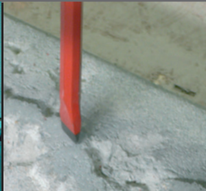
Résistance des burins, broches et chevillettes à l'aide d'un marteau-piqueur
