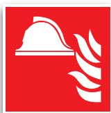
Ensemble d'équipements de lutte contre l'incendie
