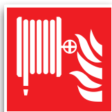
Robinet d'incendie armé
