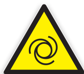
Danger, démarrage automatique
