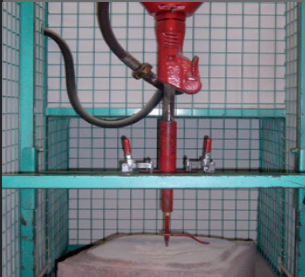
Test Rockwell : dureté de la pointe de l'outil à l'aide d'un duromètre
